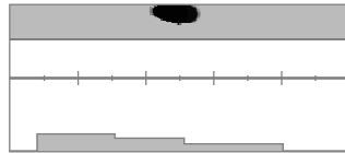
O mesmo perno de ferro ferrugento grosso analisado a partir de outra direção, mostrando mais nitidamente que é ferroso.
